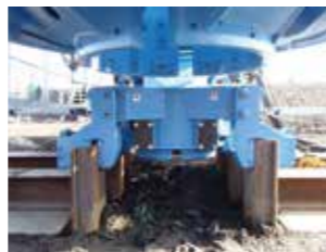
油圧クランプ式反力架台
