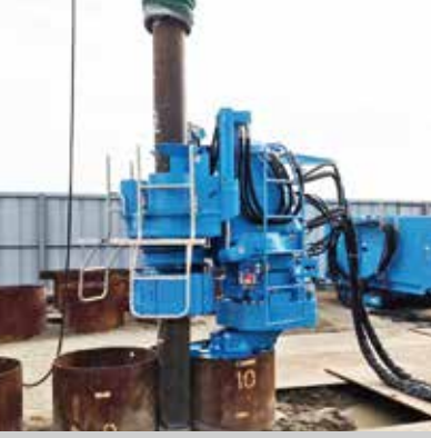
小口径専用圧入機 適用本杭径 φ800 ~ 1500 (φ1100除く)
