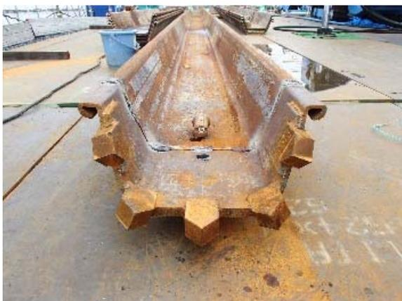
一般部にてビット付鋼矢板にて超低空頭ハ° 1 ーの能力以下のトン数で破碎できるか確認
