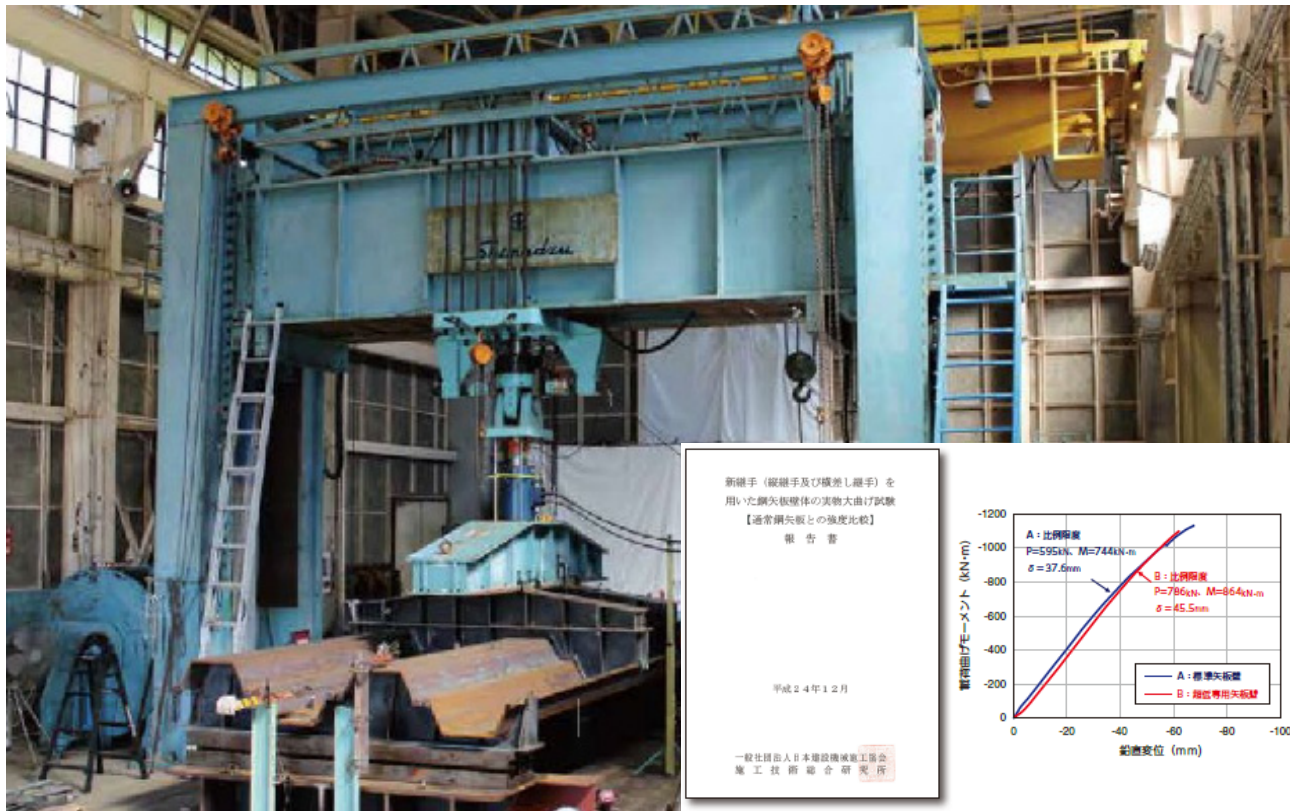
壁体性能評価（一般社団法人日本建設機械施工協会 施工技術総合研究所）
