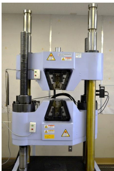
引張強度確認（高知県工業技術センター）
