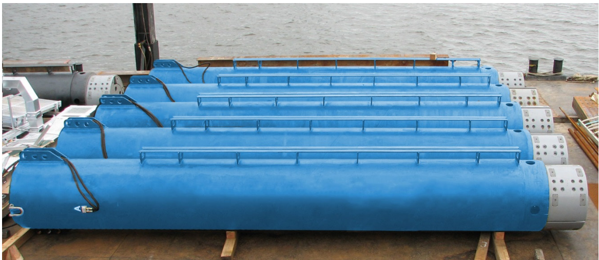
6 本の「ECO リアクションベース」を杭上に設置して順次圧入する
