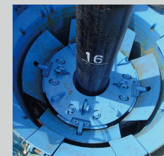
小口径チャック (ジャイロパイラー使用) 適用本杭径 φ800 ~ 1500 (φ1100除く)
