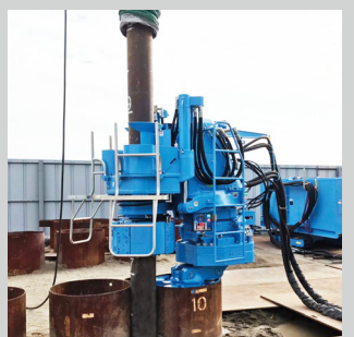
小口径専用圧入機 適用本杭径 φ800 ~ 1500 (φ1100除く)
